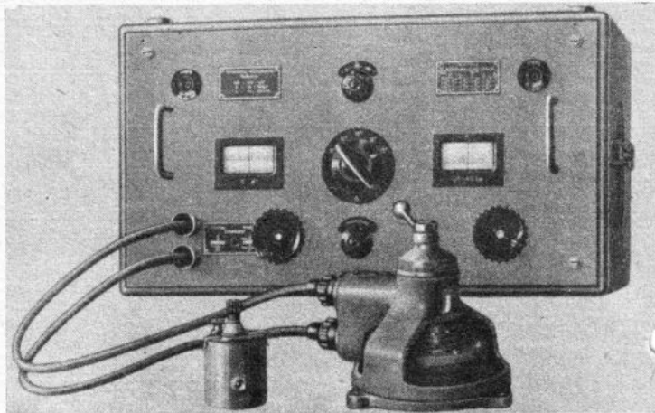
Bild 1. Verlustfaktor- und Kapazitäts-Meßbrücke von Rohde & Schwarz
